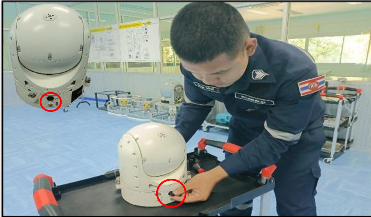
2.1 ถอดฝาครอบวาล์วทางเข้าไนโตรเจนในส่วนง่าม (Azimuth Gimbal)
