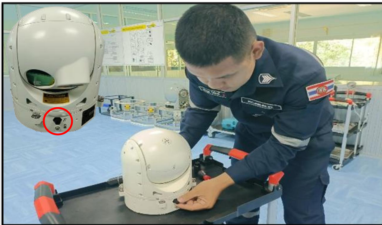
2.13 ปิดฝาครอบวาล์วทางเข้าไนโตรเจนในส่วนง่าม (Azimuth Gimbal)
