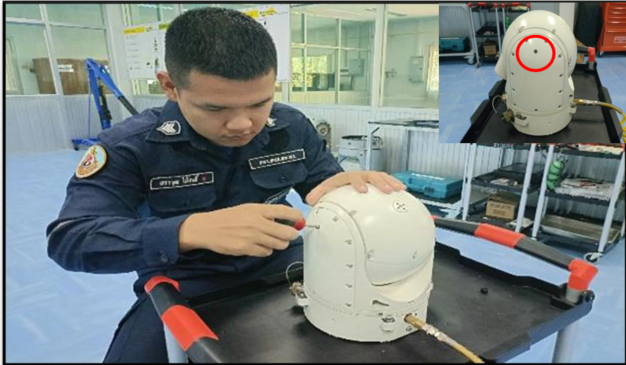
2.4 เปิดสกรูช่องระบายแรงดัน จำนวน 2 ตัว โดยใช้ไขควงปากแฉก
