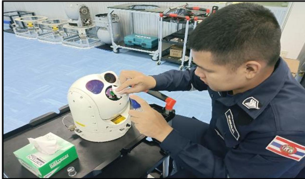
1.15 ตรวจสอบส่วนต่างๆ ที่ดำเนินการไปแล้วซ้ำอีกครั้งและทำความสะอาดกระจกหน้าต่างกล้อง
