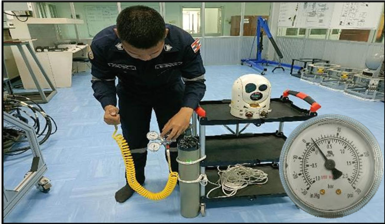
2.2 เปิดวาล์วจ่ายแรงดัน โดยใช้แรงดันต่ำไว้ที่ 1-2 psi สำหรับไล่ความชื้นในส่วนง่าม (Azimuth Gimbal)
