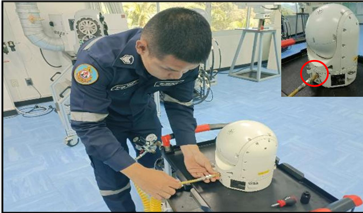
2.3 ต่อ Adapter สำหรับไล่ความชื้นเข้ากับตัวกล้องในส่วนง่าม (Azimuth Gimbal)
