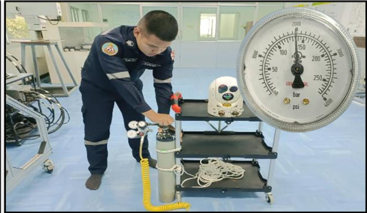
1.4 เปิดวาล์วถังไนโตรเจน ตรวจสอบแรงดันภายในถังต้องไม่ต่ำกว่า 1,000 PSI (เต็มถัง 2,200 PSI)
