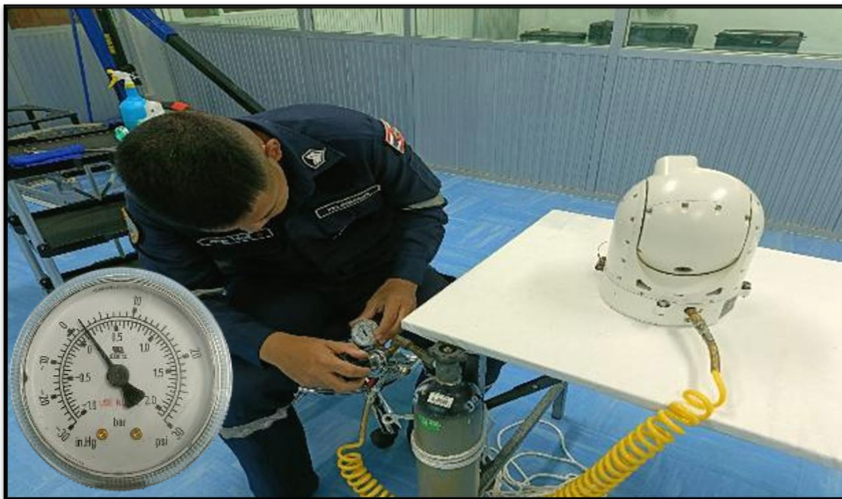
2.8 เมื่อไล่ความชื้นครบ 20 นาทีแล้ว ให้ตรวจสอบว่ายังมีความชื้นอยู่ภายในกล่องอีกหรือไม่ หากไม่มีให้ลดแรงดันของก๊าซไนโตรเจนโดยปรับวาล์วจ่ายแรงดันไว้ที่ 1-2 psi
