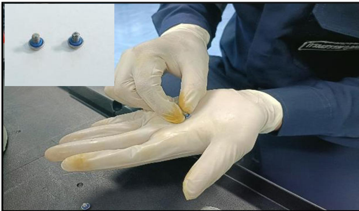
2.7 ตรวจสอบสภาพ O-Ring ว่ายังอยู่ในสภาพที่ดีหรือไม่ (O-Ring ควรมีความยืดหยุ่น ไม่แข็ง อยู่ในสภาพสมบูรณ์ ไม่เสียหาย) และให้ทำจาระบีซิลิโคนบน O-Ring สกรูช่องระบายแรงดัน
