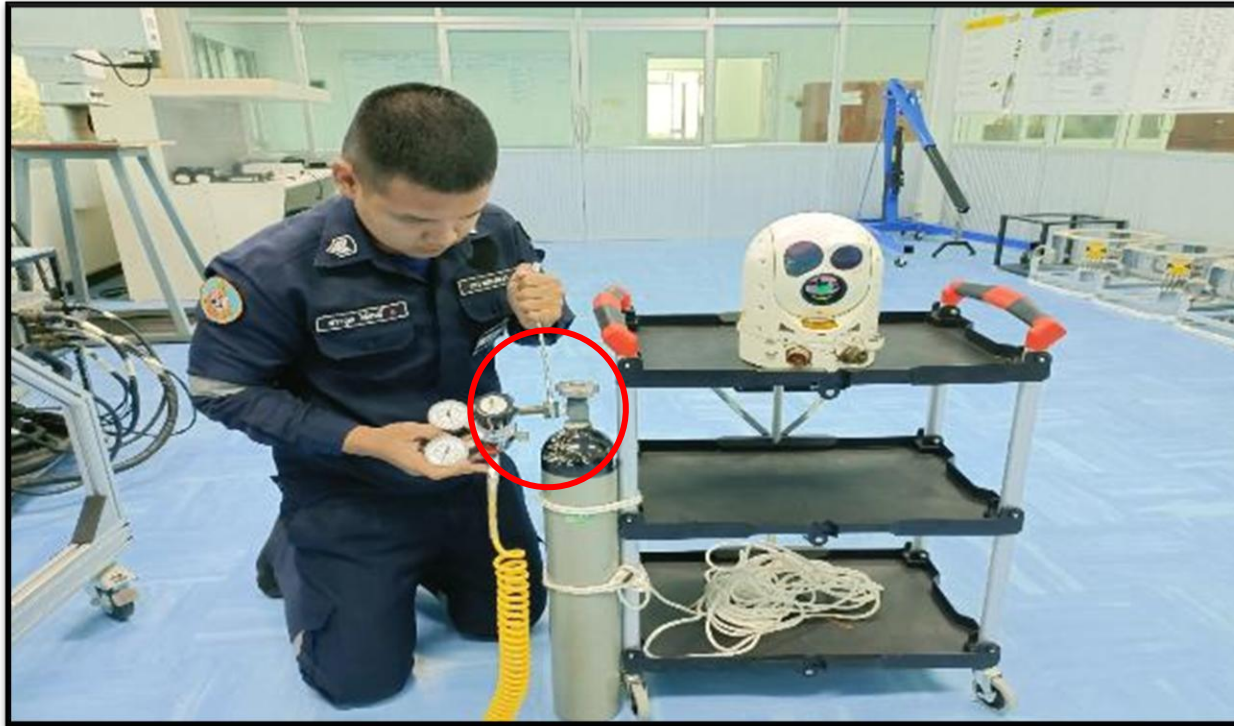
1.3 ต่อชุดมาตรวัดแรงดันเข้ากับถังไนโตรเจน ชั้นให้แน่นโดยใช้ประแจปากตาย เบอร์ 28
