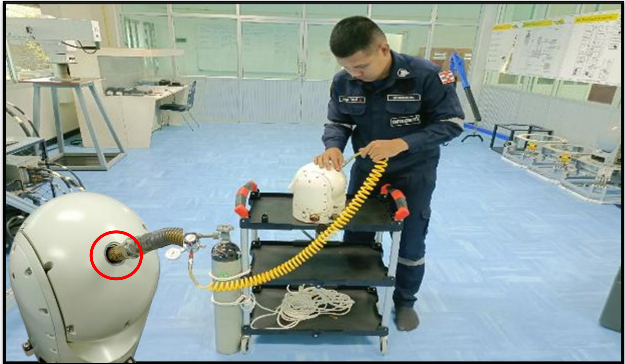
1.6 ต่อ Adapter สำหรับไล่ความชื้นเข้ากับตัวกลิ้งในส่วนทรงกลม (Pitch Gimbal)
