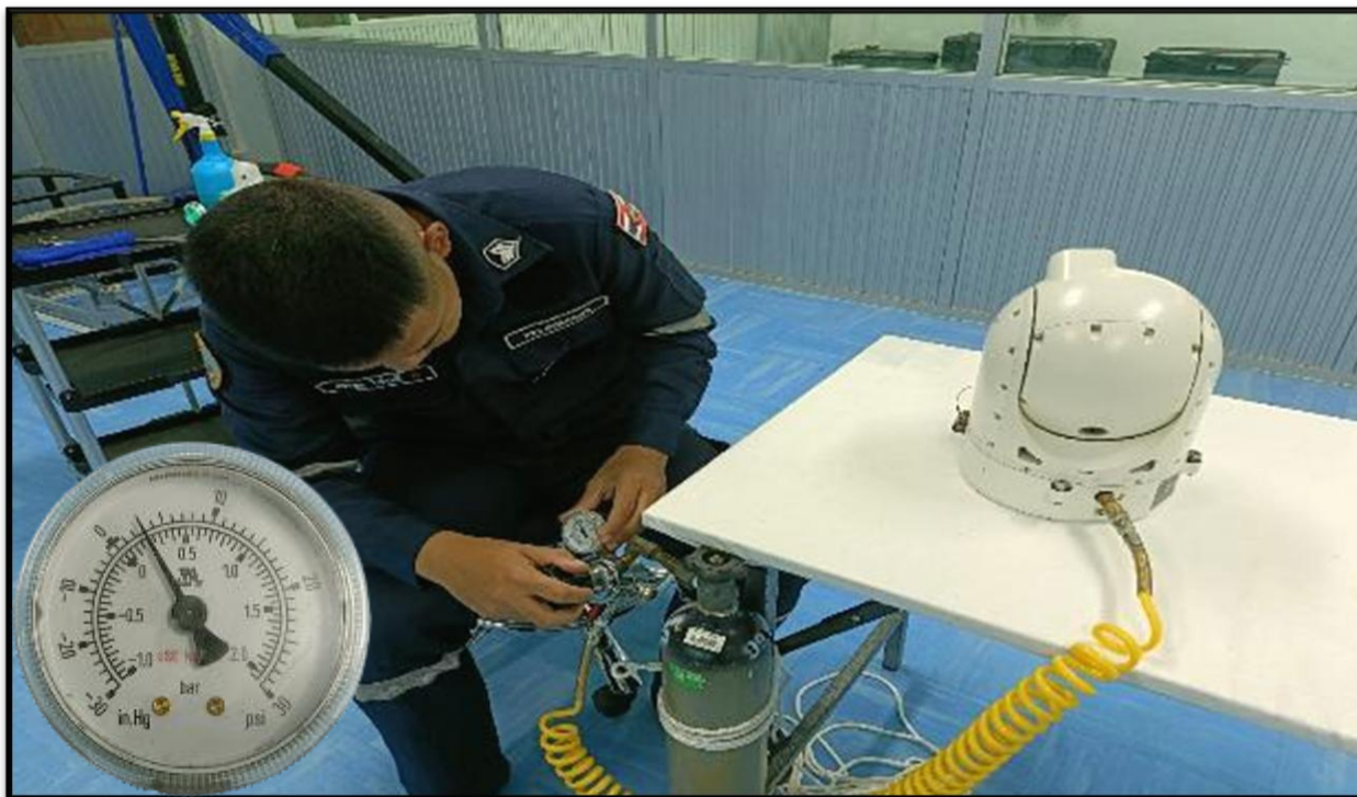
2.5 หลังจากเปิดสกรูระบายแรงดันให้เพิ่มแรงดันก๊าซไนโตรเจนโดยปรับ วาล์วจ่ายแรงดันไว้ที่ 3-4 psi
