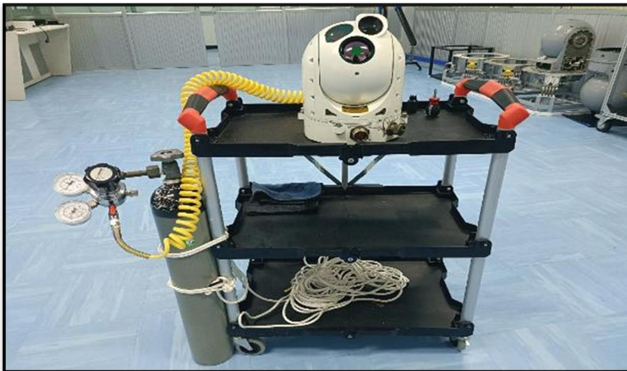
2.6 ปล่อยให้ก๊าซไนโตรเจนไหลผ่านส่วนง่าม (Azimuth Gimbal) เป็นเวลา อย่างน้อย 20 นาที ในขณะที่เปิดสกรูช่องระบายแรงดัน
