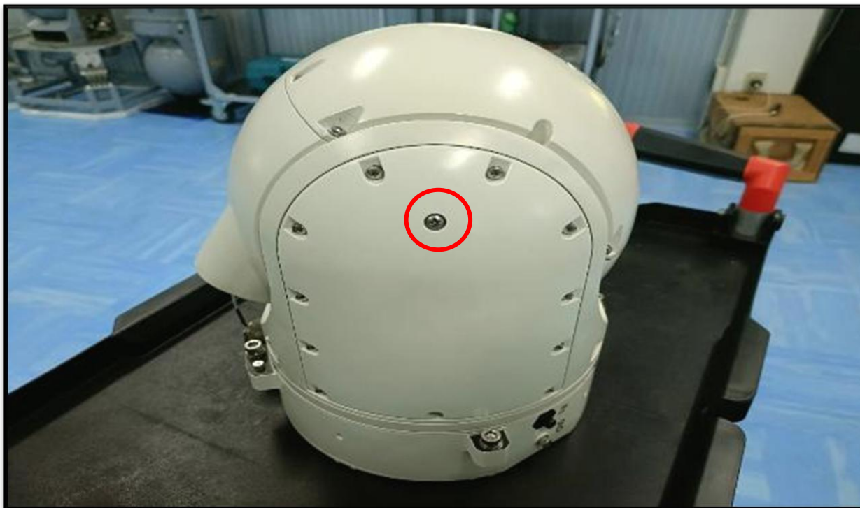
2.10 ตรวจสอบให้แน่ใจว่าสกรูทั้ง 2 ด้าน อยู่ในตำแหน่งที่ถูกต้องหรือไม่
