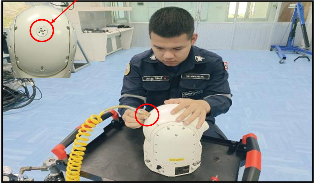
1.14 ถอด Adapter สำหรับไล่ความชื้นออกจากตัวกล้องในส่วนทรงกลม (Pitch Gimbal) และปิดฝาครอบวาล์วทางเข้าไนโตรเจนโดยใช้ อุปกรณ์พิเศษ
