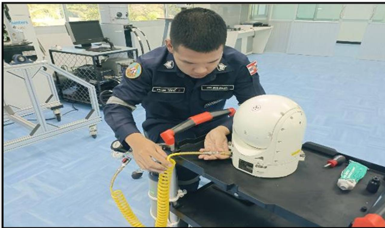
2.12 ถอด Adapter สำหรับไล่ความชื้นออกจากตัวกล้องในส่วนทรงง่าม (Azimuth Gimbal)
