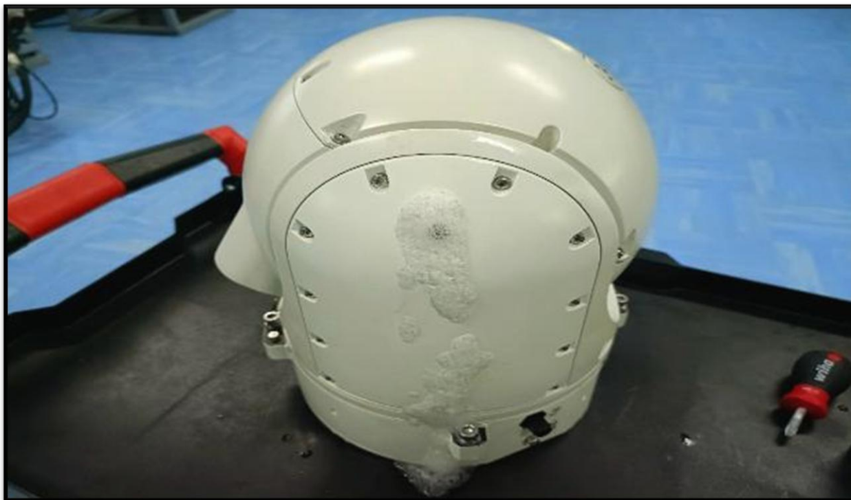
2.11 ใช้น้ำยาตรวจรั่วเพลงบนช่องระบายแรงดันทั้ง 2 ด้าน เพื่อตรวจสอบว่ามีการรั่วไหลของไนโตรเจนหรือไม่
