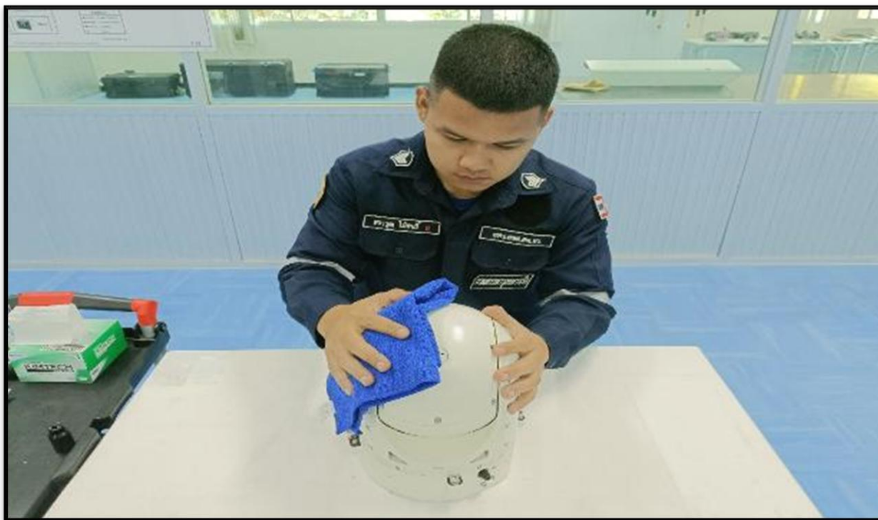
2.14 ตรวจสอบส่วนต่างๆ ที่ดำเนินการไปแล้วซ้ำอีกครั้งและทำความสะอาดกระจกหน้าต่างกล้อง
