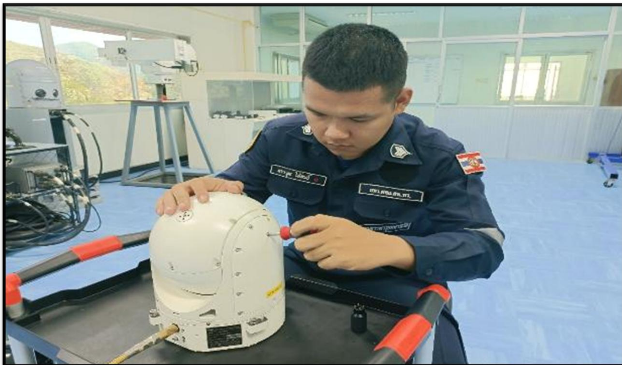
2.9 ประกอบสกรูช่องระบายแรงดันจำนวน 2 ตัว กลับเข้าไปในตำแหน่งเดิมโดยใช้ไขควงปากแฉก
