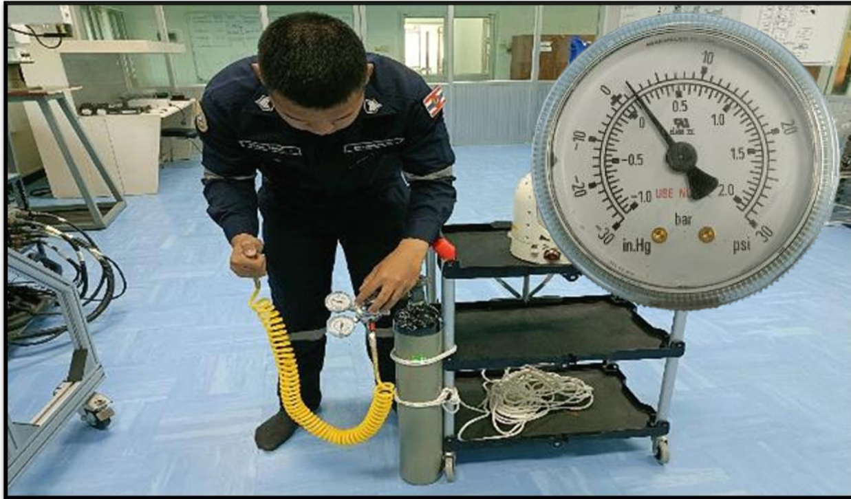
1.5 เปิดวาล์วจ่ายแรงดัน โดยใช้แรงดันต่ำไว้ที่ 1-2 psi สำหรับไล่ความชื้น ในส่วนทรงกลม (Pitch Gimbal)
